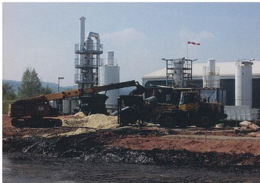
Рис. 8 Установка по производству твердого кускового замещающего топлива
